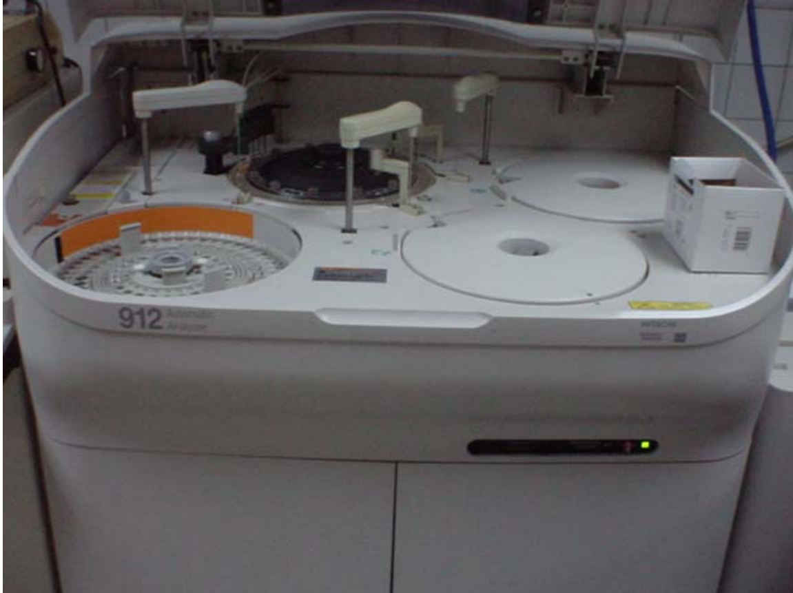
Fig. 2 Espectrofotómetro automático (Roche Hitachi 912®) usado para analizar los niveles de la actividad de AST
